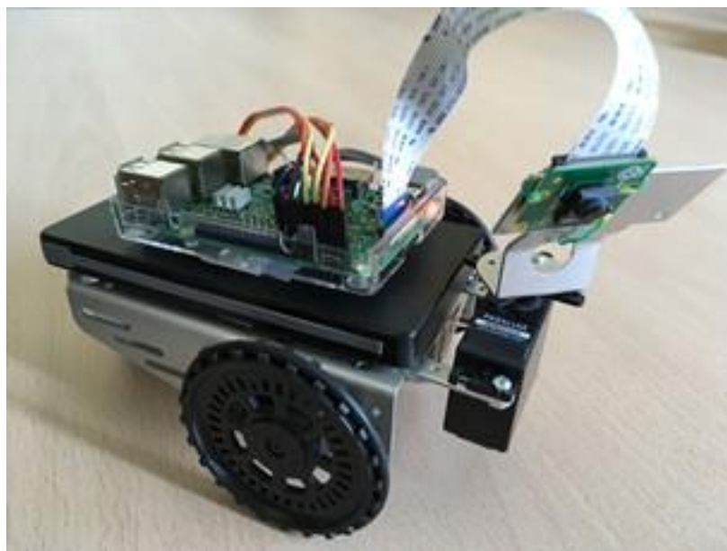
Figura 1. PiBot con su PiCamera montada en una unidad panorámica
